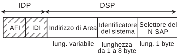
Figura 5 Struttura dell'indirizzo per l'instradamento ISO
