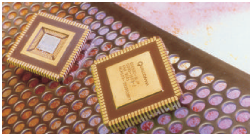
Un recente circuito integrato della Qualcomm, con decodificatore Viterbi ad alta velocità.
