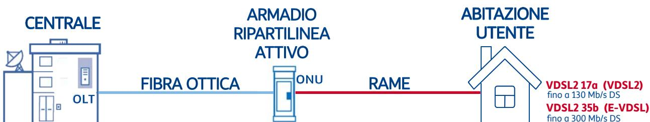
Con la soluzione FTTCab (rame + fibra) la rete di distribuzione primaria in fibra ottica chiamata ODN (Optical Distribution Network) parte dalla centrale, la quale è dotata di un apparato concentratore (Optical Line Termination OLT) e termina in un mini-Dslam che necessita di alimentazione elettrica, posto sulla sommità dell'armadio ripartilinea della rete in rame già esistente. Gli utenti sono collegati al Cabinet mediante il doppino in rame (rete secondaria).
